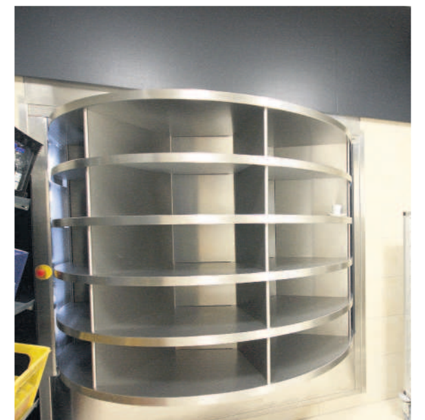
Die Geschirrrückgabe erfolgt über ein Karussell – so ließ sich in der dahinter liegenden Spülküche Platz sparen.
